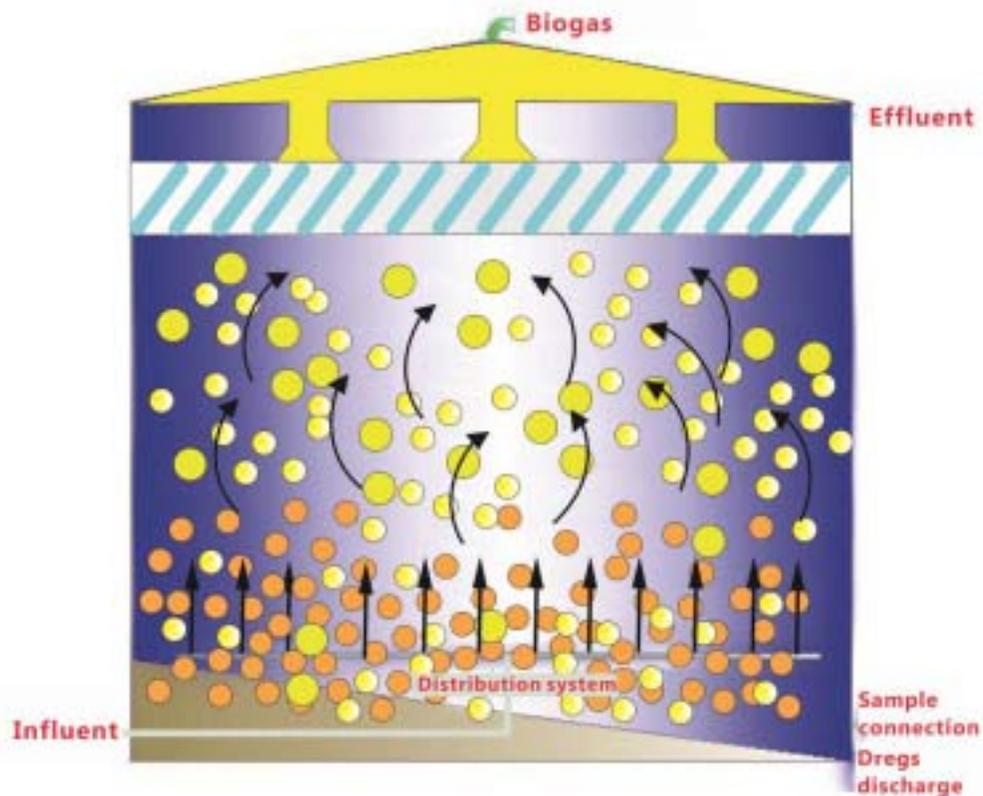
BSAR主要由进水配水系统、污泥反应区、气/固液分离系统、排渣系统等组成。废水由反应器底部的配水系统均匀布水进入污泥反应区，污泥反应区始终保持膨胀状态，强化厌氧菌与有机物的传质效果，使厌氧反应充分，提高产气效率；气/液分离区实现沼气与泥水分离并收集至沼气稳压柜作为能源利用，反应器出水液面设置固液分离装置，将泥水分离，降低出水的SS含量；渣及污泥则通过污泥排渣系统均有排出。
